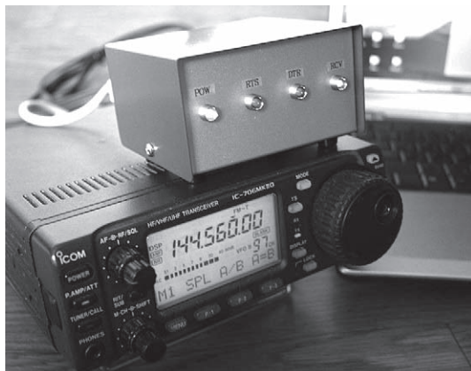
写真1-2 I/Fを介しPCと無線機を接続
