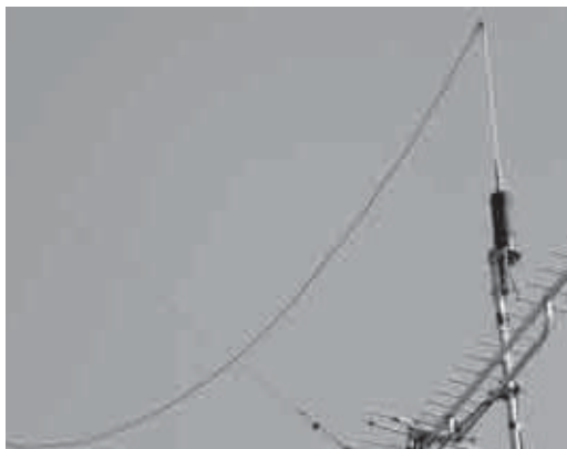
写真4-2 ベランダなどに電線を引っかけた簡易なものでもかまわないので、何かしらの屋外アンテナを用意しよう
