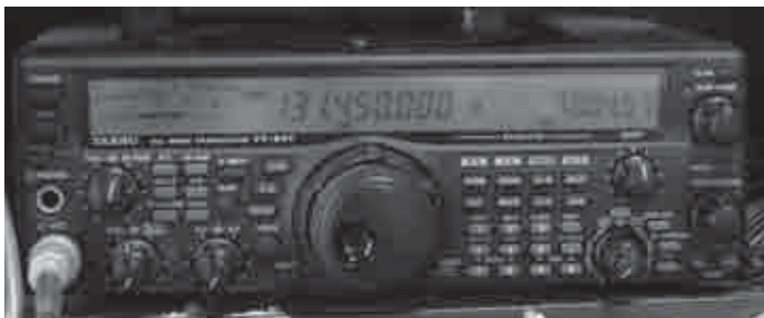
写真4-1 HFDLの信号はアマチュア無線のHFトランシーバのHF帯ゼネラルカバレッジ機能を使って受信できる。写真はYAESUのFT-847
