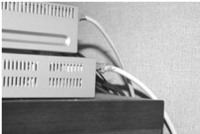
アンテナからTVセットまでは同軸ケーブルで受信電波を導く 同軸ケーブルやコネクタの使い方は第3章で詳細に解説している
