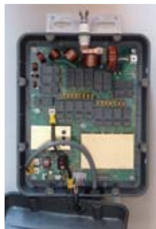
▶屋外設置型アンテナ・チューナの内部のようす
