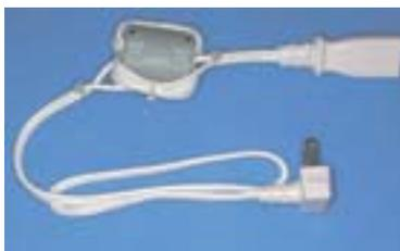
◀パッチン・コアを使ったACライン用コモン・モード・フィルタを製作してみた。材料と事務用カッターがあれば簡単に自作できる
