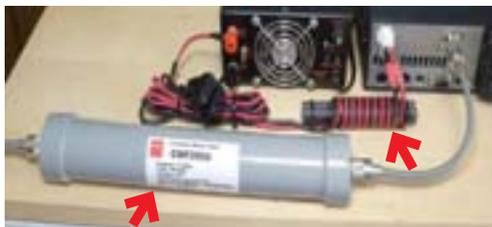
▲トランシーバの電源ラインと同軸ケーブルにコモン・モード・フィルタを装着
