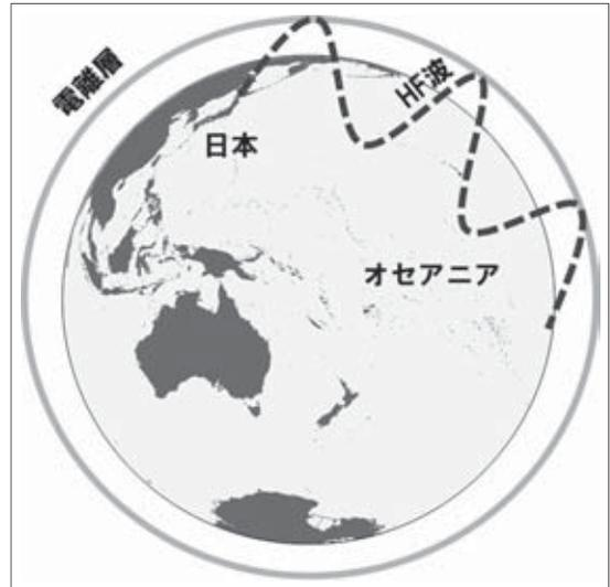
図1-2 HFの電波は電離層と呼ばれる地球大気の一部によって反射される。そのため、電離層反射と地上反射を繰り返すことで海外まで飛んでいく
