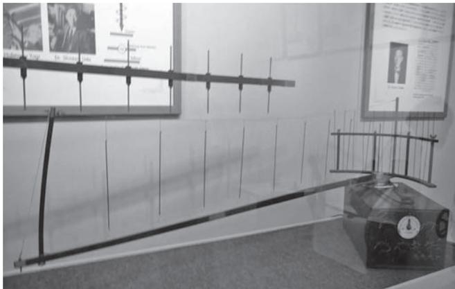
UHF (670MHz) 帯の八木・宇田アンテナ (東北大学電気通信研究所の展示)
