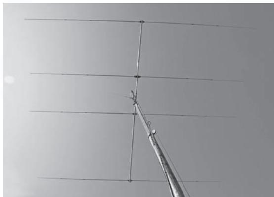
クリエート・デザイン 4エレメント18MHz YAGIアンテナ
