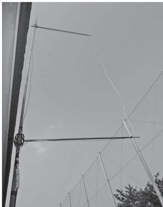
写真7-1 1エレメントのタテ長クワッド・アンテナ
