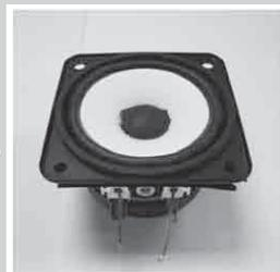
オーディオ回路は、パワー・アンプを中心にSPICEシミュレータが得意とする回路分野です。オーディオ用パワー・アンプの負荷はスピーカです。多くの場合、 $8\Omega$ あるいは $4\Omega$ の抵抗で代用しますが、スピーカのインピーダンスには周波数特性があり、周波数によらずほぼ一定の値を持つ抵抗とは異なります。そこで、パワー・アンプの負荷にスピーカを表す周波数特性モデルを採用すると、周波数特性の再現性が向上します。
