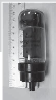
Western Electric社の三極真空管300BのSPICEモデルを作成して、シングル電力増幅回路のシミュレーションをしてみます。300Bは出力段の増幅回路に採用され、初段、2段目の後に接続されるのが一般的ですが、今回は、仮想的な単段のシングル電力増幅回路を作ります。
