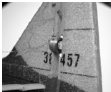
写真7-4 自作したマグネット・アクチュエータ
