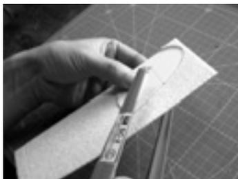
(b) 水平尾翼の切り出し。止まらずに切る。引っかかったときはニクロム線を外側に逃がす
