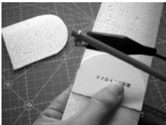
写真10-7 翼端を切り出し、整形する
