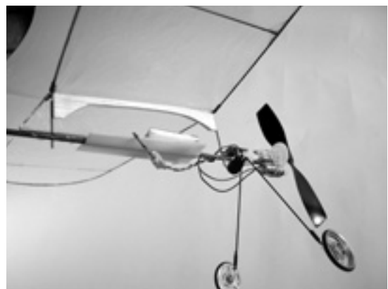
写真6-27 メカニカル・ファスナで電池を取り付ける メカニカル・ファスナはスリーエム社製品で、オスとメスをあわせた厚さが1mmもない。
