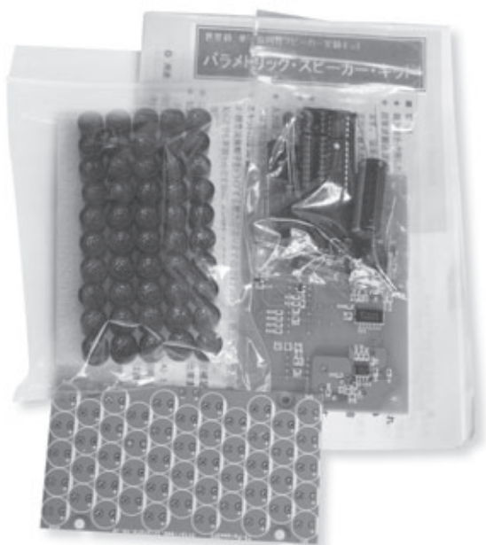
写真1-1-1 キットの内容。50個のトランスジューサ（超音波発振子）が目を引く
