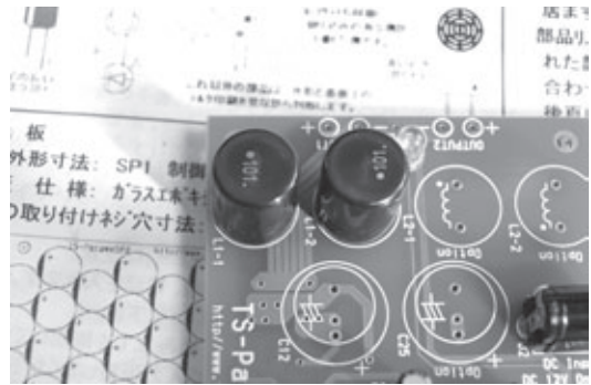
写真1-1-5 二つの L_1(L_{1-1}, L_{1-2}) はこの向きで取り付ける
