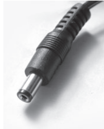
写真1-2-3 ACアダプタに付いているDCプラグの形状を確認しておく。これにあわせてケースに取り付けるDCジャックを購入する
