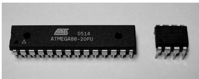
写真1-1 AVRマイコンの外観(左：ATmega88 28ピンDIP，右：ATtiny45 8ピンDIP)
