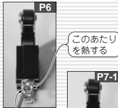
③ スイッチの端子とビニール線を同時にコテ先で熱して、つなぎます。はんだが少なすぎたなら、少しはんだを足します。もしスイッチの端子の穴はんだで埋まったときは、端子を熱してはんだが溶けている間にビニール線を穴に差し込んでもかまいません。
