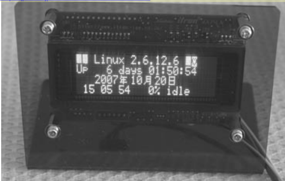
写真6-4 VFDにlcdprocの表示をしたところ
