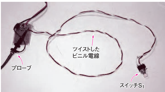
写真2-1 実験の様子(スイッチと1mのツイスト・ペア・ケーブル)
