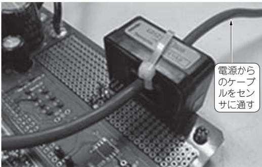
写真4-C センサの取り付け例
