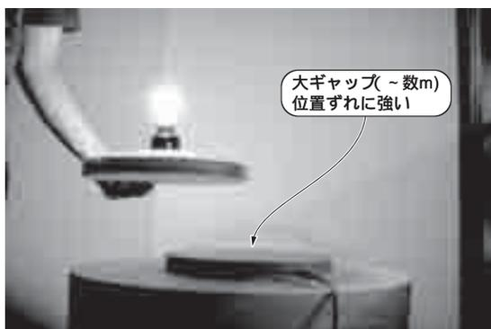
写真2-1 磁界共振結合によるワイヤレス電力伝送
