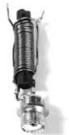
写真6-2 メーカー製バランの内部の一例
