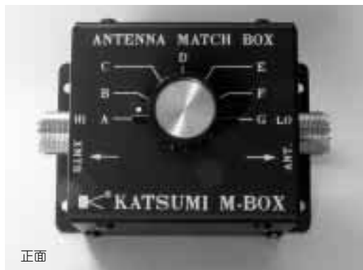
写真9-1 メーカー製のマッチング・ボックスの一例 T-130#2を2段重ねてLを構成している
