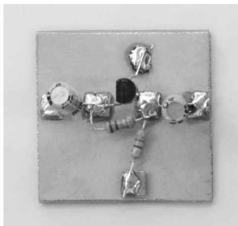
写真1-3-10 2SC1815を使ったマイク・アンプ基板 (実寸：35×35mm)
