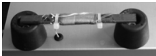
AMラジオに使われているバー・アンテナ(磁界型アンテナ)
