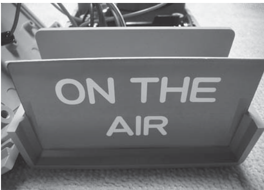
写真3-4-2 メッセージ・パネルを挟み込むように加工することで、パネルを簡単に交換できる。パネルの加工については後述
