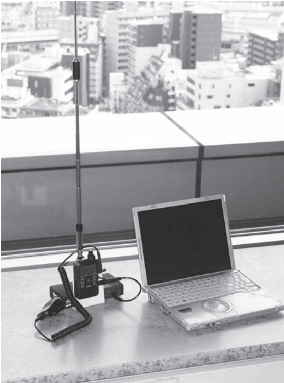
写真2-1 ハンディ機とホイップ・アンテナを使った運用の例
