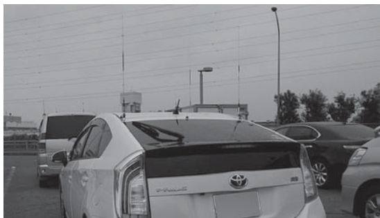
写真1-18 1200MHzに対応したモバイル 右側のアンテナは144/430MHz、左側が1200MHz用
