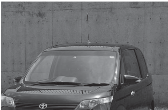
写真1-17 典型的な144/430MHzのアンテナを取り付けたモバイル局の例
