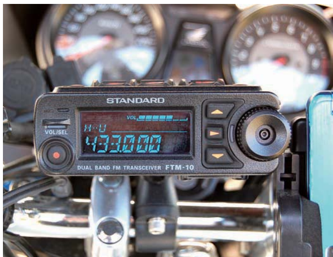
バイクへの無線機とアンテナの取り付け
