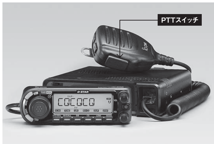
写真1-1 モービル機(車載用無線機)のPTTスイッチ
