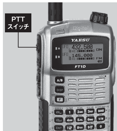
写真1-2 ハンディ機(手に持つタイプの無線機)のPTTスイッチ
