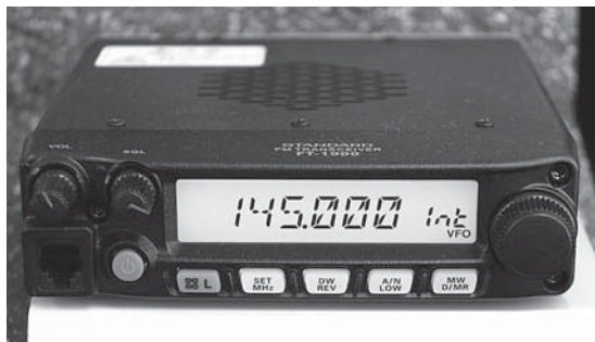
写真1-19 144MHzの呼び出し周波数にあわせた無線機(例) 八重洲無線 144MHz FMTランシーバFT-1900
