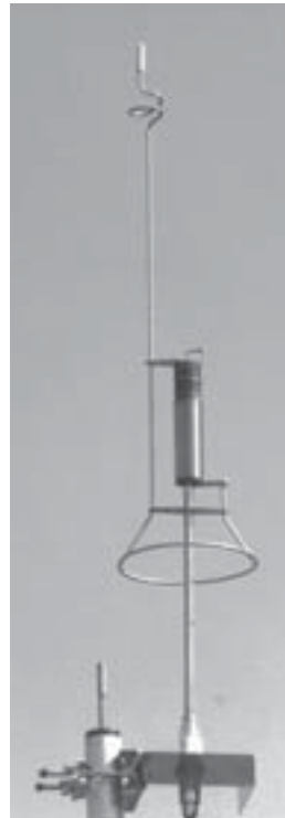
写真4-3-3 7MHz用アストラプレーン・アンテナ
