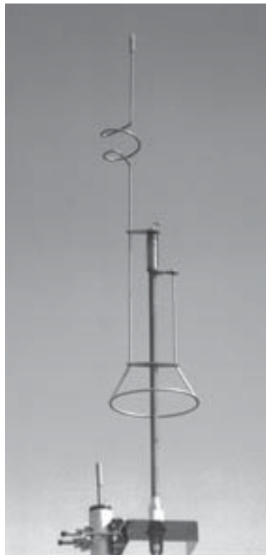
写真4-3-2 21MHz用アストラルプレーン・アンテナ
