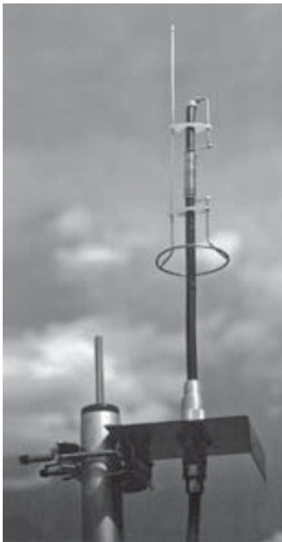
写真4-3-1 430MHz用アストラルプレーン・アンテナの同軸ケーブル上にコイルを巻き、HF化する実験を行った
