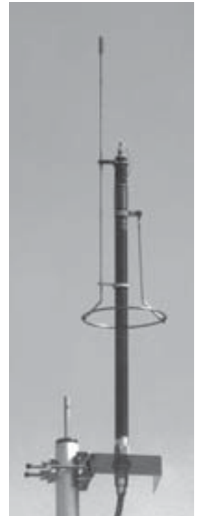
写真4-3-4 50MHz用アストラプレーン・アンテナ。ブームは釣竿で内側には5D-2V同軸ケーブルを利用している
