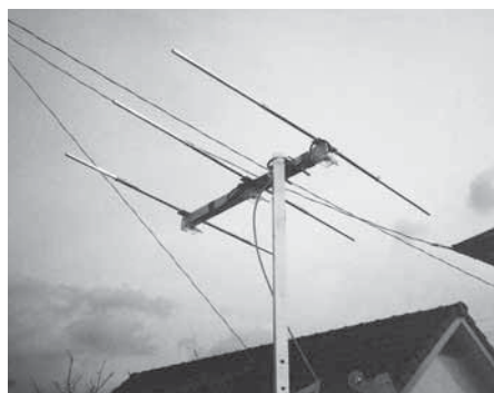
写真2-1-1 144MHz 3エレ同時励振アンテナの外観
