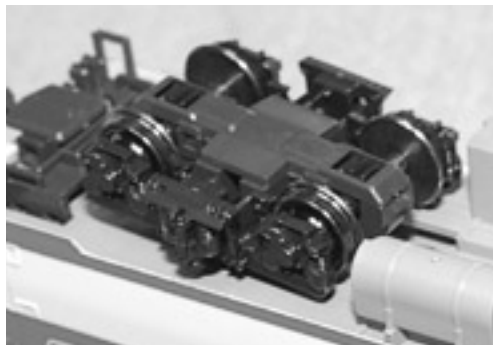
写真1-7 片側の台車で集電する車両もある
