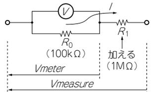
[図2-7] 抵抗  $R_1[\Omega]$  を加えてみる
