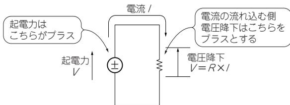
【図2-5】 抵抗の電圧降下の考え方
