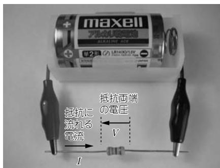
[図2-2] 抵抗で消費する電力を考える回路
