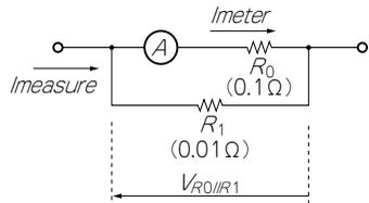
[図 2-9] 抵抗  $R_1$  [Ω] を加えてみる (測定電流レンジ拡大のため)
