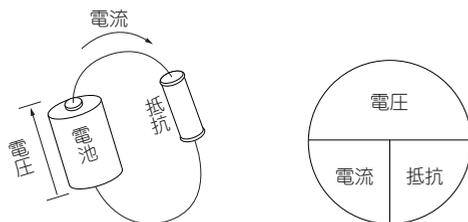
[図2-1] オームが定義した電圧と電流と抵抗の関係
