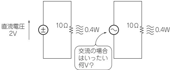
[図4-1] 抵抗に直流電圧を加えた場合と交流電圧を加えた場合で同じ電力を生じさせるには？
