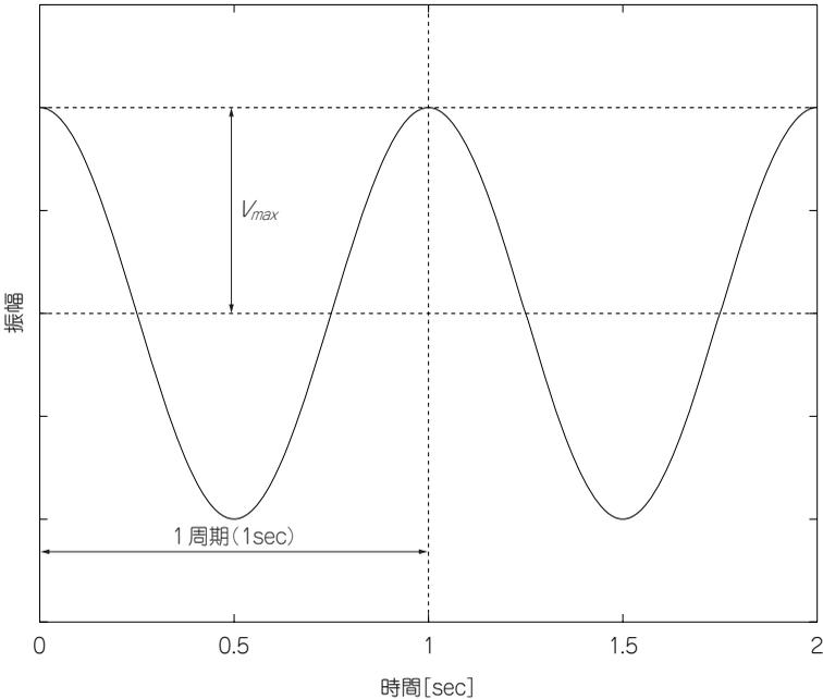
(a) 振幅  $V_{max}$  のコサイン波  $V_{max} \cos(2\pi ft)$
