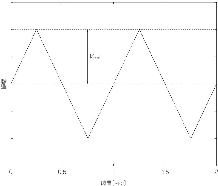
(a) 振幅  $V_{max}$  の三角波
