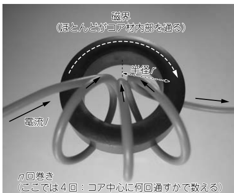
[図8-4] トロイダル・コアとアンペアの周積分の法則 (本来ならコアに密着して、均一に巻いていく)
