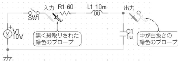
図1.15 測定プローブ(周波数アナライザ)の接続
