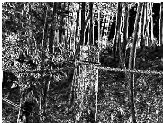
図1 水平方向のソーベル・エッジ の強度（絶対値）画像
