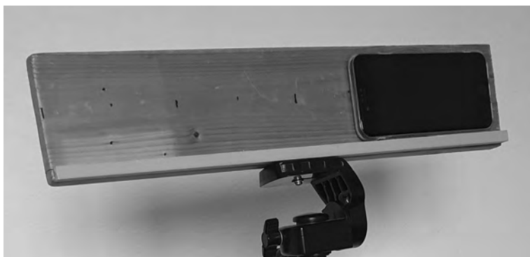
写真1 スマホでステレオ画像を作るための治具
