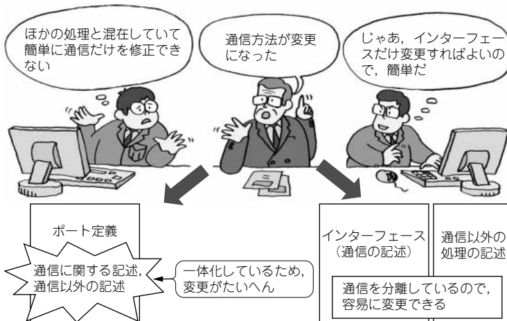
図2-4 インターフェースの利点 モジュール間の通信(インターフェース)では、ポート定義と通信用の記述を行う。これまでは、通信以外の処理の記述といっしょになってしまっていることが多く、通信方式の変更はかなりめんどうだった。インターフェースの概念を利用し、通信の処理を分離して記述すれば、通信方式の変更や再利用が容易になる。
