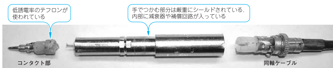
写真3 プローブ・ヘッドの構造
