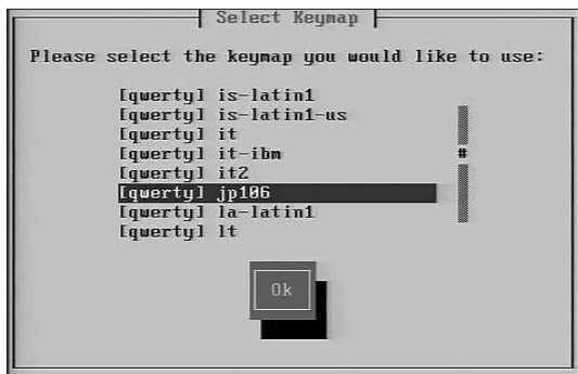
図5.4 日本語キーボードを選択 今回は日本語キーボードを使っているので[query] jp106を選択した。TABキーでハイライトをOKボタンに移しENTERキーを押して確定する。
