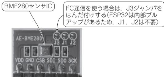
写真1-1 BME280センサ・モジュール
