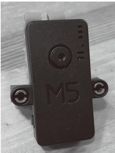
写真1 ESP32マイコンとカメラ・モジュールを搭載するM5Camera M5Stack社が販売している。ESP32と、2Mピクセル・イメージセンサOV2640が標準準備されている
