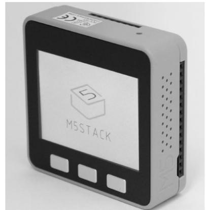
写真3 ESP32が入ったカラー液晶付きキットM5Stackは便利で持ち運びやすい
