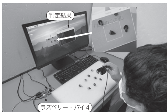
写真1 画像ディープ・ラーニングによるお菓子判定をラズベリー・パイで行う
