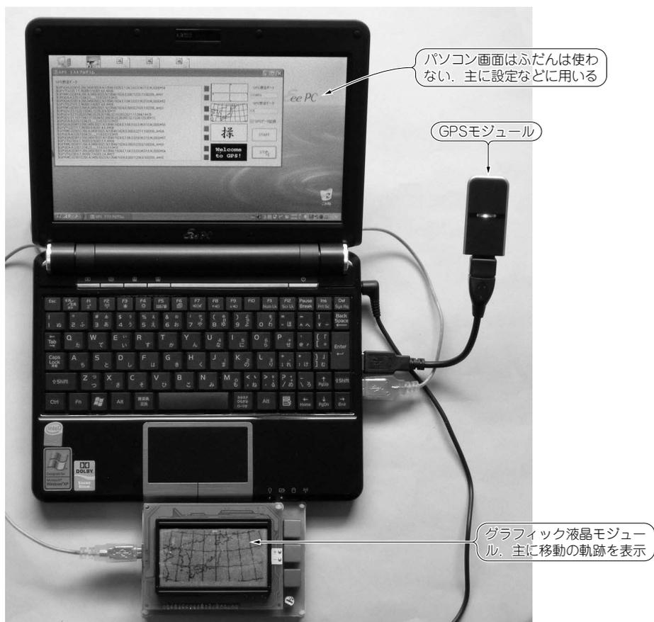
写真10-1 フォックス・ハンティング機として利用するGPSモジュールとグラフィック液晶ディスプレイ・モジュールおよびパソコン
