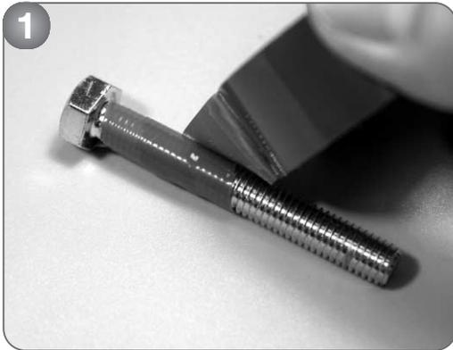
鉄製のボルトにビニール・テープを巻きつけます。端の5mmくらいを残して、ねじ山の部分をかくすように巻きます。テープが少し伸びるかな？ くらいの力で引っ張りながら巻くと、きれいに巻くことができます。
