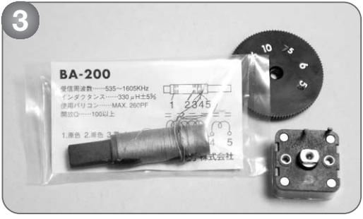
バー・アンテナとバリコン、バリコンに取り付けるダイヤルです。バー・アンテナにはBA-200という型番のものを 사용합니다。バリコンは、AMストレート・ラジオ用を使用します。
