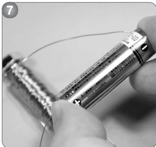
ここで、電磁石がちゃんとできているか試してみます。新しい乾電池の出っぱり（プラス極）と、その反対側の銀色で平な部分（マイナス極）に、エナメル線のひふくをはがした部分をギュッと押し付けてください。
