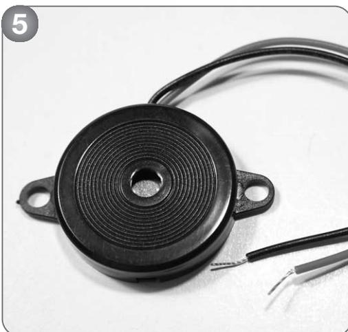
圧電サウンダは、UM66Tからの電気信号を音に換える素子(スピーカ的一种)です。
