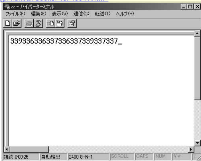
図6-9 リスト6-3 (b)をターミナル・ソフトで動作させる 任意の1文字を送信すると計測が行われ3桁の数字が送信される。
