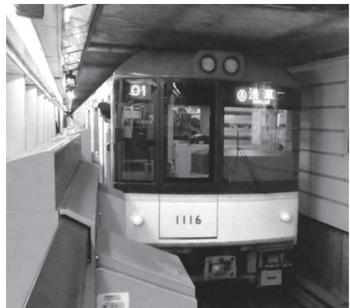
写真1 非常用電源にSCiBを搭載する東京地下鉄 銀座線1000系——停電時に最寄り駅まで移動できる容量の電池を搭載
