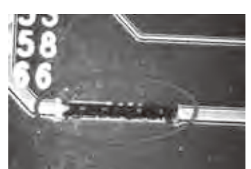
写真2 その気になれば太いプリント・パターンもカットできる
