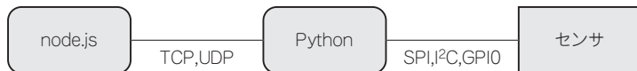
図 4-19 Python プログラムを介して、センサ値を TCP/IP 経由で読み出す
