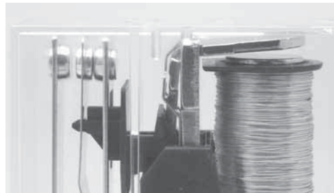
写真4.2 リレーの接点の拡大写真(左半分が接点、右半分が電磁石 写真では右側の接点につながっている)
