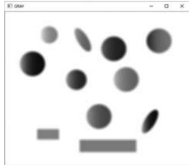
前処理では、カラー画像をグレー・スケール化し、ノイズ除去のためにぼかし処理をします(図16)。後は、`HoughCircles()`を使用して円形状を検知するだけです。検知情報は中心座標と半径の情報を受け取ります。受け取った座標データを基に円を描画します。
