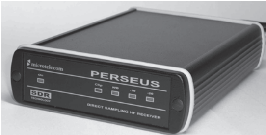
写真1 アナログ・ミキサを使わずダイレクトに電波をA-Dコンバータに入力するタイプの受信機の例 FPGAを内蔵し、RF信号を処理する。SDR(Software Defined Radio)とも呼ぶ
