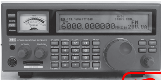
写真1 実際のSDR無線機(AR5001D, AOR)はCICフィルタを利用している
