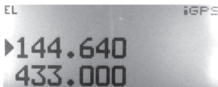
写真2-23 APRS運用周波数を上段に設定
