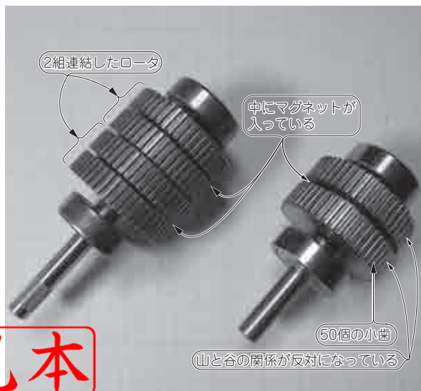
〈写真9-3) HB型ステッピング・モータのロータ
