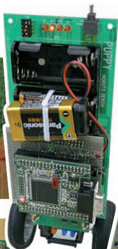
ロータリ・エンコーダとジャイロ・センサを用いた倒立ロボット
