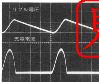
〈写真1-2〉 両波整流回路のリプル電圧と充電電流波形 (上 ; 0.5V/div , 下 ; 0.5A/div , 2ms/div )
